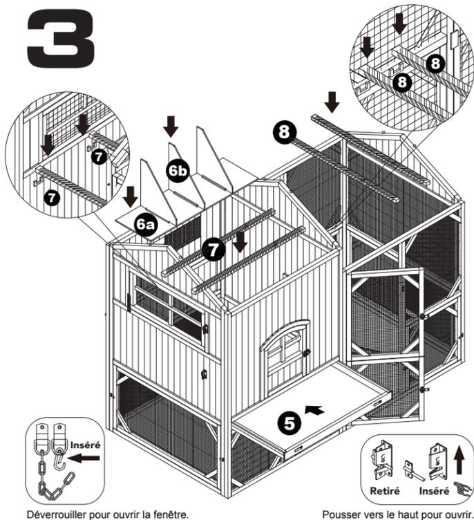
Insérez le plateau de nettoyage (5). Insérez le panneau de plancher du nichoir (6a) et les séparateurs de nichoirs (6b). Insérez les barres de perchoir internes (7). Insérez les barres de perchoir externes (8).
