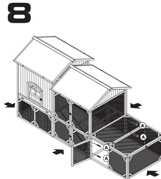
Pour fixer le KS-008 et le KS-007, suivez le côté avec la flèche avec les vis (A).
