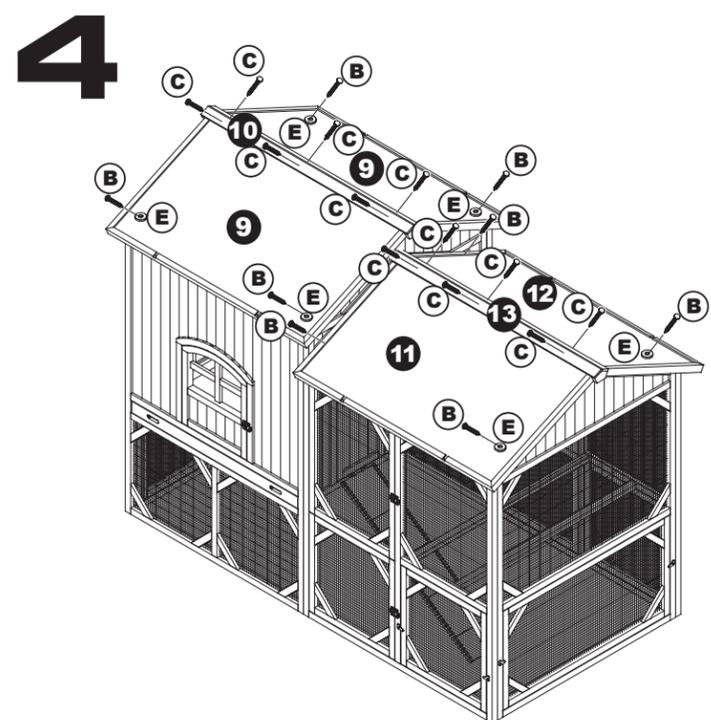
Fixez le toit de l'aire de perchoir (9) et le toit de la zone d'alimentation (11, 12) à l'aide de vis (B) et de rondelles en plastique (E). Fixez le chapeau du toit de l'aire de pont (10) et le chapeau du toit de l'aire d'alimentation (13) avec les vis (C).
