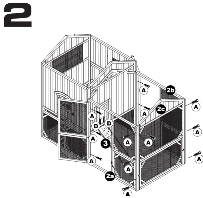
Fixez les panneaux de l'aire d'alimentation (2a, 2b, 2c) à l'aire de perchoir avec des vis (A). Fixez la rampe (3) avec les vis (D).
