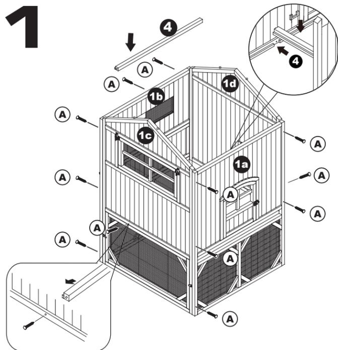
Fixez les panneaux de l'aire de pont (1a-d) à l'aide de vis (A). Insérez la barre de raccordement (4) avec des vis (A) - suivez la flèche jusqu'aux trous pilotes. Fixez le panneau central de l'aire de pont (1d) à l'aide de vis (A).
